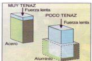
Figura 4.8(g). Tenacidad. Resistencia que opone un cuerpo a su rotura cuando está sometido a esfuerzos lentos de deformación.
