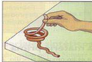
Figura 4.8(b). Plasticidad. Habilidad de un material para conservar su nueva forma una vez deformado. Es opuesta a la elasticidad.
