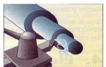
Figura 4.8(i). Maquinabilidad. Facilidad que tiene un cuerpo a dejarse cortar por arranque de viruta.
