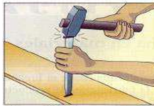
Figura 4.8(e). Dureza. Oposición que ofrece un cuerpo a dejarse rayar o penetrar por otro o, lo que es igual, la resistencia al desgaste.
