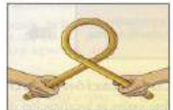
Figura 4.8(c). Ductilidad. Es la capacidad que tiene un material para estirarse en hilos (por ejemplo, cobre, oro, aluminio, etc.).
