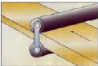
Figura 4.8(d). Maleabilidad. Actitud de un material para extenderse en láminas sin romperse (por ejemplo, aluminio, oro, etc.).
