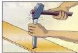
Figura 4.8(e). Dureza. Oposición que ofrece un cuerpo a dejarse rayar o penetrar por otro o, lo que es igual, la resistencia al desgaste.
