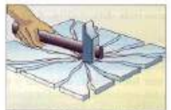
Figura 4.8(f). Fragilidad. Es opuesta a la resiliencia. El material se rompe en añicos cuando una fuerza impacta sobre él.
