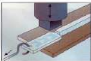
Figura 4.8(j). Acritud. Aumento de la dureza, fragilidad y resistencia en ciertos metales como consecuencia de la deformación en frío.
