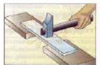
Figura 4.8(l). Resiliencia. Resistencia que opone un cuerpo a los choques o esfuerzos bruscos.
