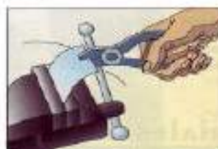
Figura 4.8(h). Fatiga. Deformación (que puede llegar a la rotura) de un material sometido a cargas variables, inferiores a la de rotura, cuando actúan un cierto tiempo o un número de veces determinado.
